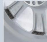
ブレーキとウェルのクリアランスが少ないため、アウターウエイトは「スロークラッチの根元部」に貼り、右記画像のように「分割」するなどし、対応してください。
