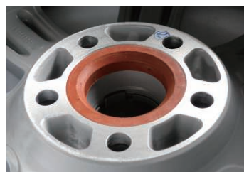
ハブリング仕様のBORBETホイールにハブリングを装着した状態のハブ面
