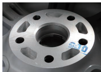
車種専用のBORBETホイールのハブ面
